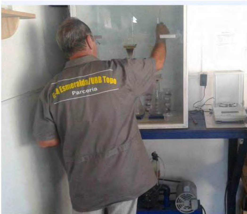
Figura 18 - Os trabalhos de determinação da %THM (total heavy minerals) no laboratório da empresa existente na Cidade do Prado e que possibilitaram definir a RESERVA MEDIDA no Processo DNPM 870.866/2011
